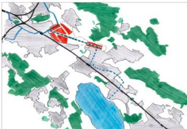
Grossräumige Lage von S-Bahn, Stadtbahn und Tram. Abb. mit Nutzung auf dem Flugplatzareal Dübendorf (rot). Anschlussmöglichkeit bietet eine Stadtbahn auf dem Flugplatzareal Dübendorf (blau gestrichelt).
