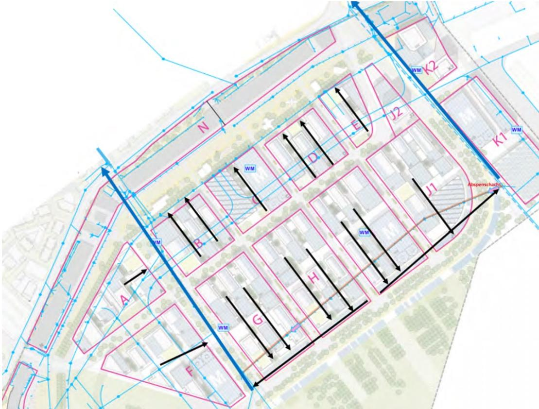
**Abbildung 17:** Planzustand Bauflächenentwässerung A (IPZ) (Quelle: [13]). Pinke Polygone stellen Bauflächen dar. Schwarze Pfeile geben die Abflussrichtung auf den Böden der Bauflächen an.
